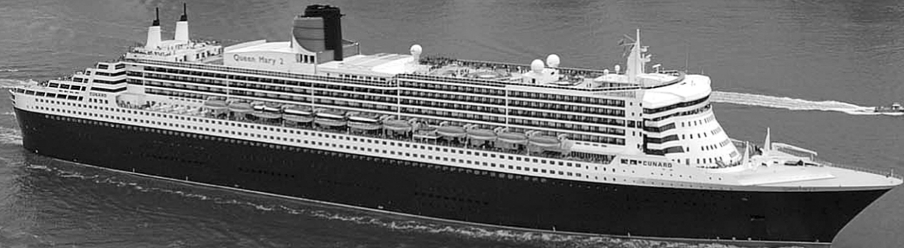
2004年のデビュー以来、米国トラベル・ウィークリー誌の「ベスト・ラグジュアリー・シップ」に毎年選ばれているクイーン・メリー2。 ■クイーン・メリー2 シップデータ: 総トン数: 151,400トン/全長: 345m/乗客定員: 2,620人
