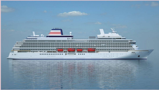
【飛鳥Ⅲ 総トン数 52,200トン 全長 230.2m 全幅 29.8m】
